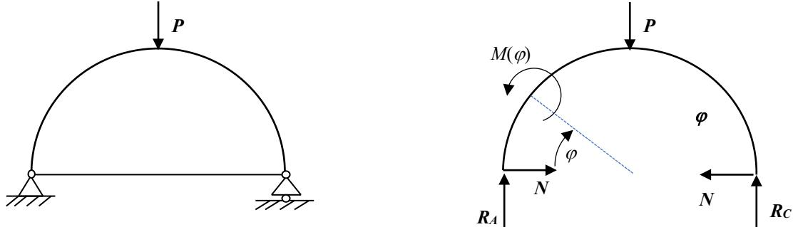
Le système est hyperstatique (intérieur) d'ordre 1, car le tirant ne peut transmettre qu'un effort de traction :  $k = m + p - 2 n = 2$  (barres) + 3 (ddl bloqués) - 2 x 2 (nœuds) = 1
